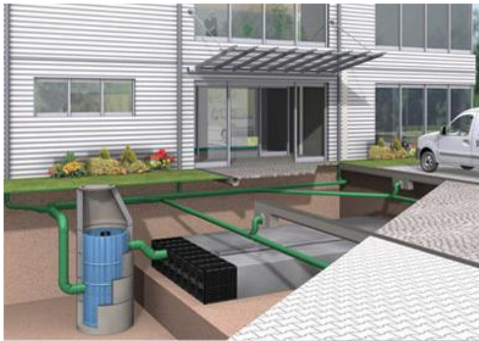
Figura 23 – Schemi di serbatoi interrati per piccole, medie e grandi installazioni (dal sito http://www.conservationtechnology.com )
