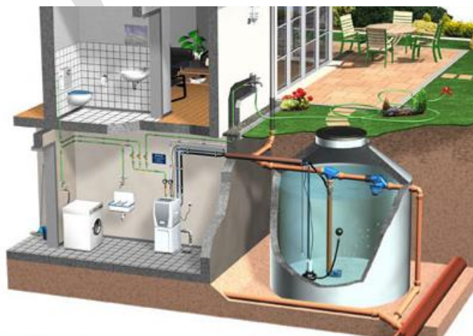
Figura 22 – Esempi di applicazione di vasche di laminazione sotterranee per piccole e medie estensioni, strutturabili sia per la sola laminazione con scarico in sistema di infiltrazione, sia per il riuso (tratte dal sito http://www.3pttechnik.it/it/home.html )
